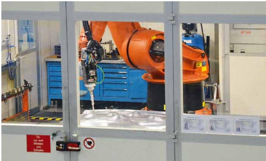
Die Roboterzelle ist mit einem Schallschutz versehen – das Geräusch der Klopfbearbeitung ist zwar nicht besonders laut, auf Dauer aber für die Mitarbeiter in der nächsten Umgebung durchaus unangenehm.
