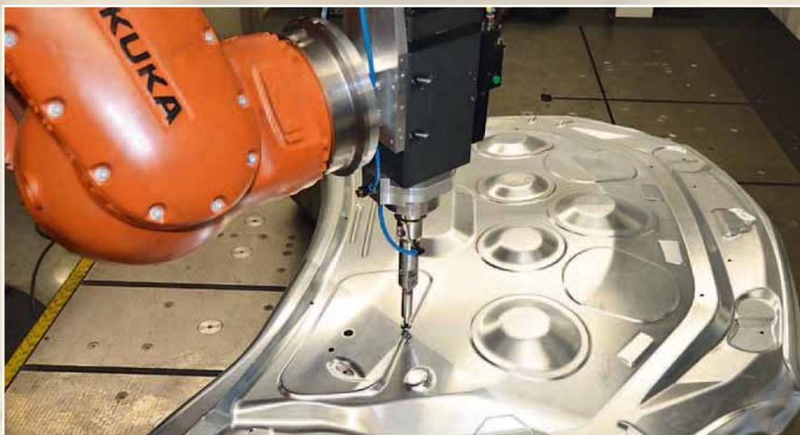
**Serienreif:** Inzwischen werden alle im Werk Sindelfingen erstellten Serien-Ziehwerkzeuge geklopft. In die Roboterzelle wollen die Verantwortlichen künftig weitere Bearbeitungsfunktionen integrieren.
