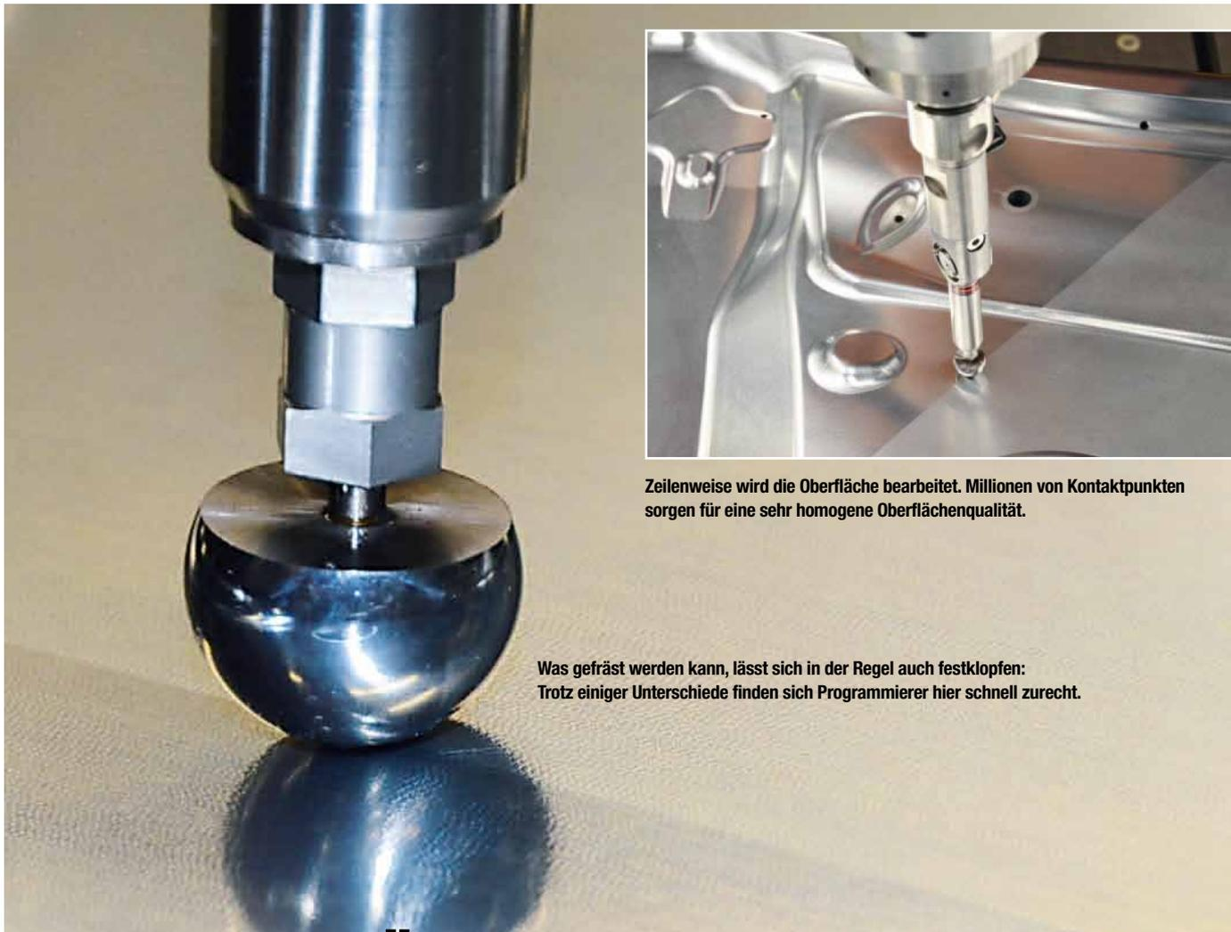
Zeilenweise wird die Oberfläche bearbeitet. Millionen von Kontaktpunkten sorgen für eine sehr homogene Oberflächenqualität.
